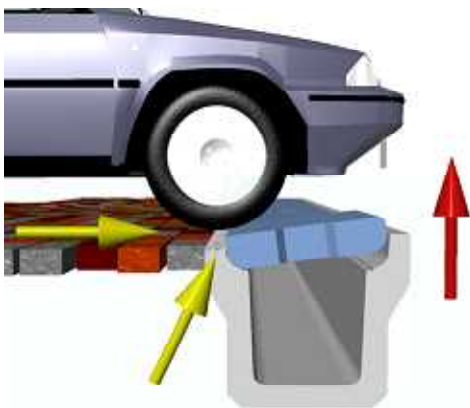
図2-6 天端が破損し車両が横断する場合 5)
