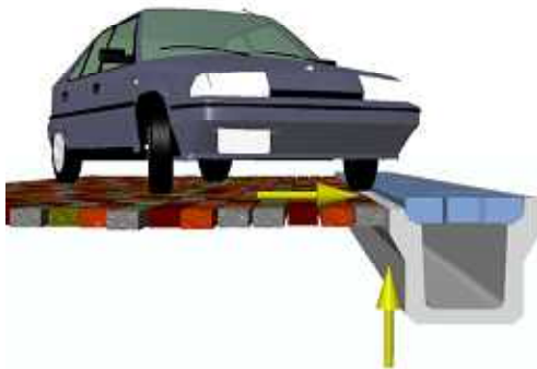
図2-4 道路が側溝より沈み、側溝の天端が破損 5)
